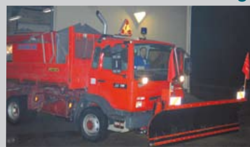
Le camion de voirie est équipé d'une lame pour déneiger et d'une saieuse de 4 m 3 de réserve.
